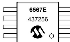
8-Lead SOIC (150 mil) (MCP6567)
