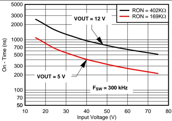
图 11.  $T_{ON}$  vs  $V_{IN}$
