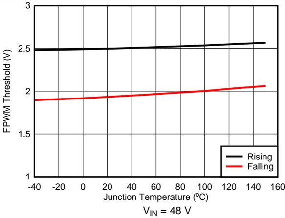
图 23. FPWM Threshold vs Temperature
