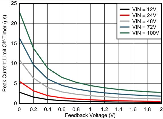
图 9.  $T_{OFF} (I_{LIM})$  vs  $V_{FB}$
