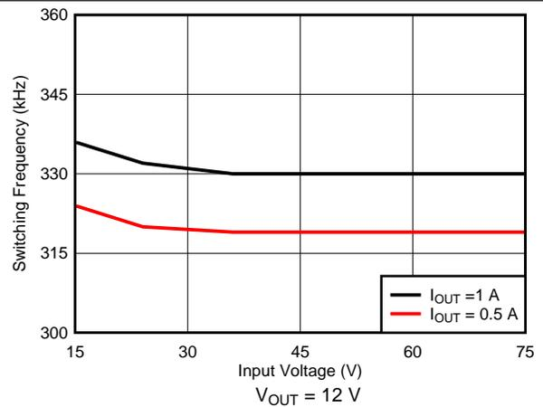
图 12.  $F_{SW}$  vs  $V_{IN}$
