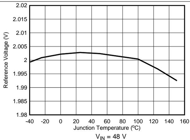
图 17. Reference Voltage vs Temperature
