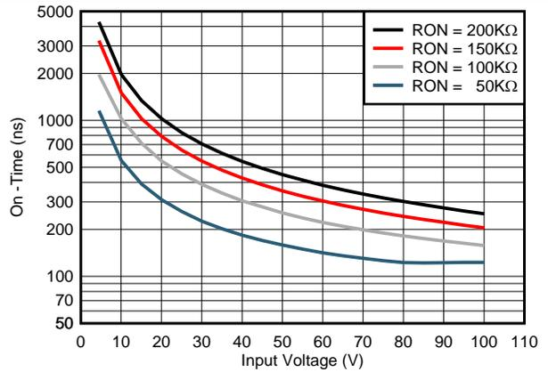
图 10.  $T_{ON}$  vs  $V_{IN}$
