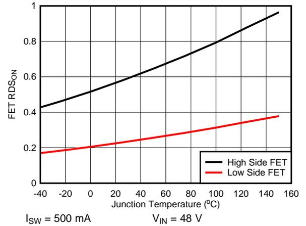
图 24. Switch Resistance vs Temperature
