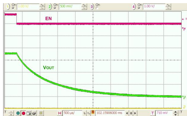
图 27. 关断, 无负载, 输出放电已启用
