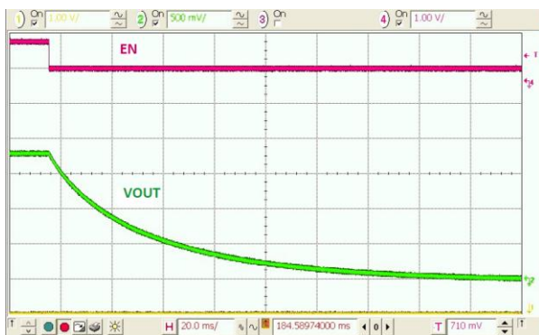
图 26. 关断, 10\text{ k}\Omega 负载, 无输出放电
