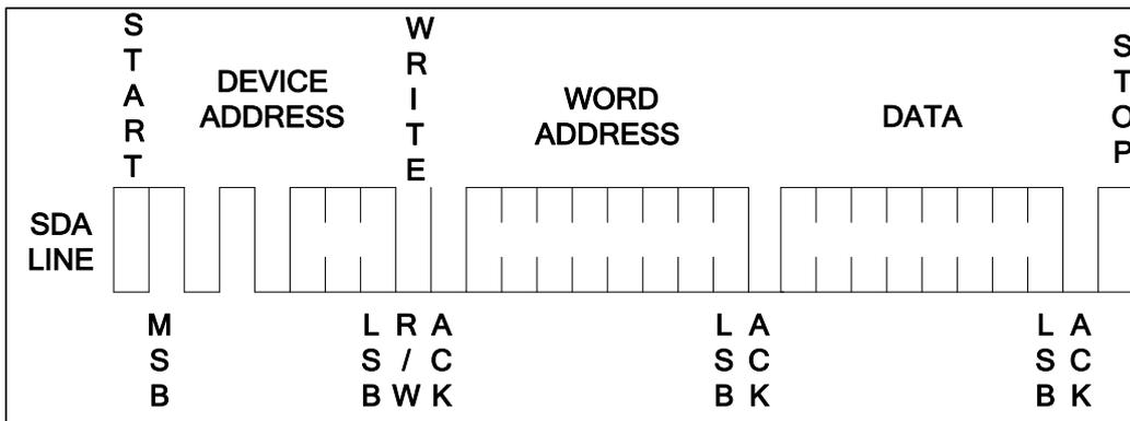
**Figure 6. Byte Write**
